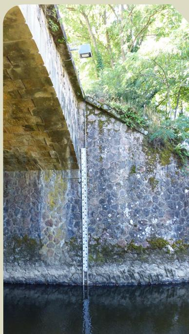
Échelle limnimétrique et capteur radar sur le Sornin à La Chapelle/Dun, pour mesurer en continu le niveau d'eau et sa température
