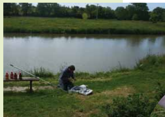
Sur le terrain sont mesurés la température, l'oxygène dissous, le pH et la conductivité. Les autres analyses chimiques sont conduites par le Laboratoire de l'Environnement et de l'Alimentation de la Vendée.
