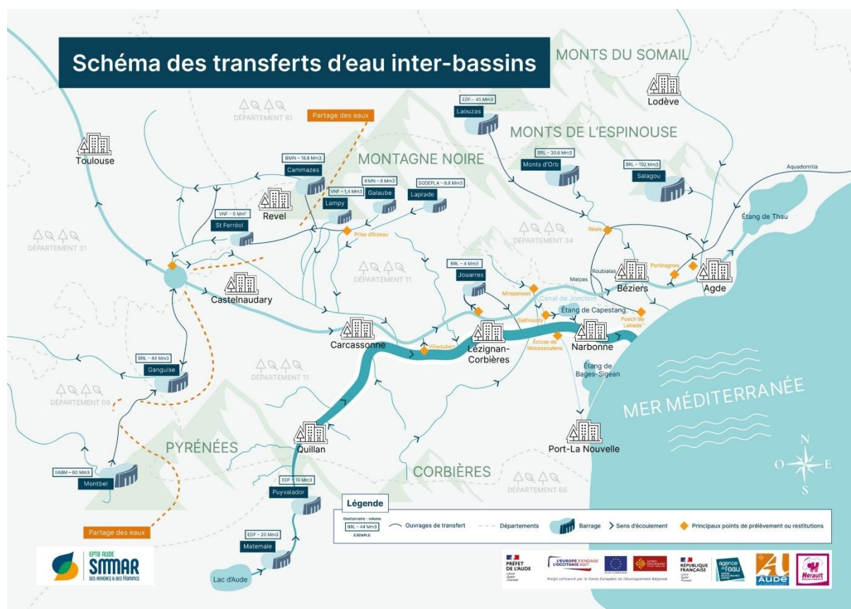
Figure 6 : représentation schématique des ouvrages composant l'hydrosystème. Source : SMMAR
