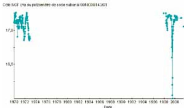
Figure 4 : Chronique piézométrique du captage d'Echinghen entre 1970 et 2000
