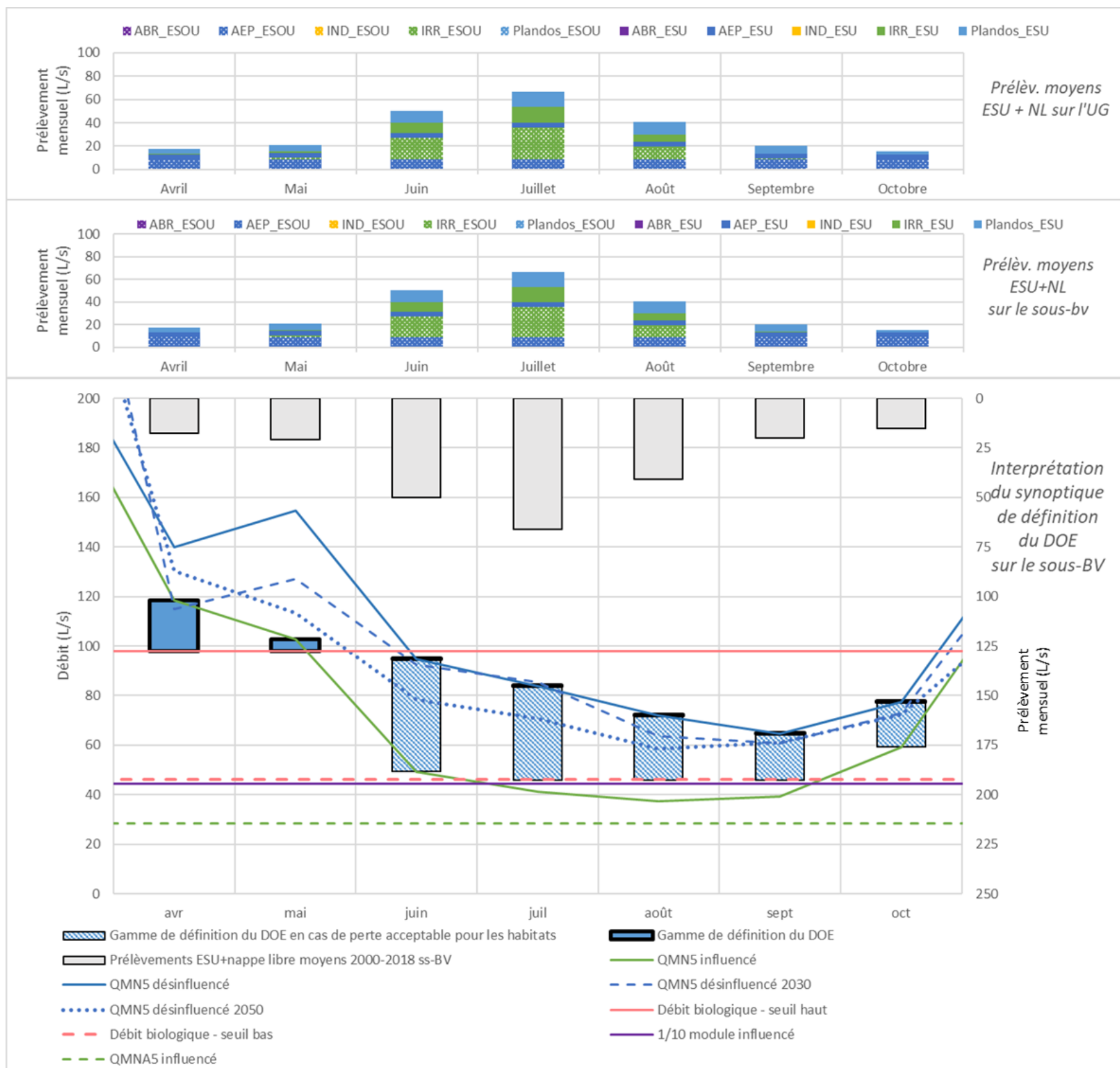
Figure 29 : Graphique d'aide à la définition des DOE pour l'unité de gestion du Fouzon amont
