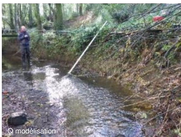
Le radier 71 (Q modélisation : 14 l/s jaugé au niveau de la station, Q2 : 532 l/s au niveau de la station de l'Issoire, à Saint Philbert de Bouaine)
