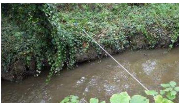
Au Q1 (78 l/s), petites sous berges fonctionnelles à 50% avec un tirant d'eau de 14 à 16 cm
