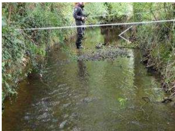
Atterrissement constitué d'éléments grossiers et radiers au Q1 (42,5 l/s)
