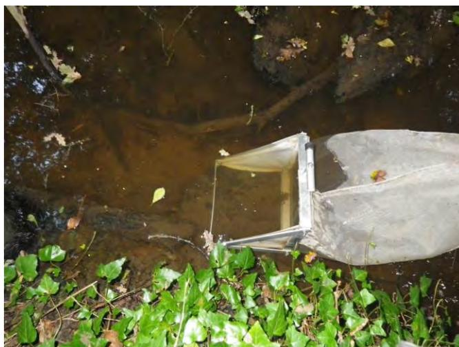
**Figure 2 : Echantillonneur de typer « Surber »**
