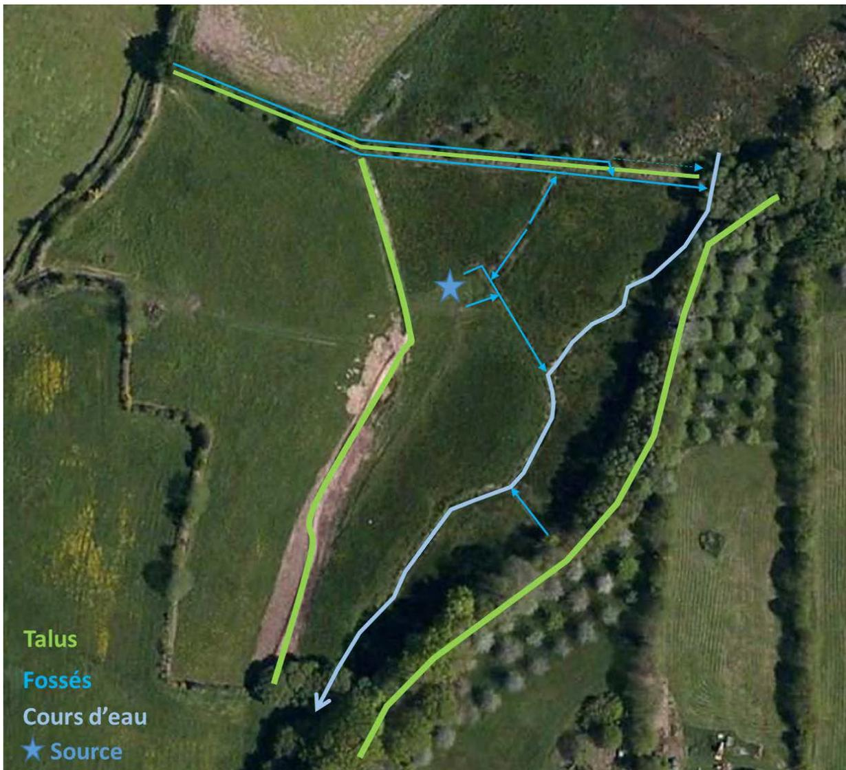
Figure 20 Contexte hydraulique du site de Coat Carriou. Les flèches indiquent le sens de circulation de l'eau.
