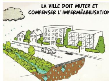
La ville doit donc muter et limiter l'imperméabilisation. L'eau ne peut plus s'infiltrer à la parcelle, mais elle peut être gérée à l'échelle d'un quartier. Il faut alors infiltrer ces eaux de ruissellement durant leur transport.
