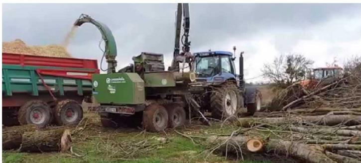
Broyeur à copeaux, bois bocage
