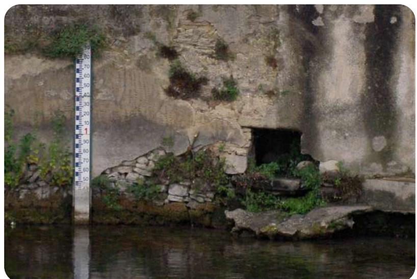
Échelle limnimétrique pour mesurer le niveau d'eau de la rivière
