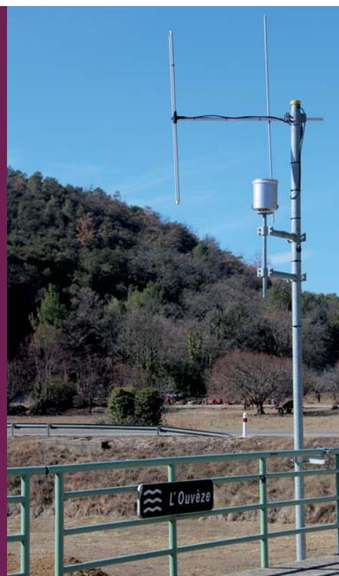
Station hydrométrique sur l'Ouvèze pour observer et mesurer les hauteurs d'eau et débits.
