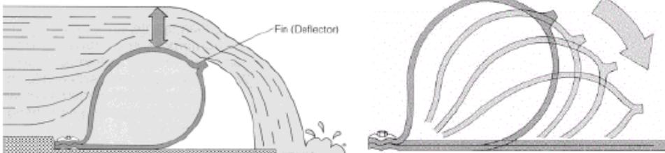
Fig. 2. Principe de fonctionnement d'une bouchure gonflable
