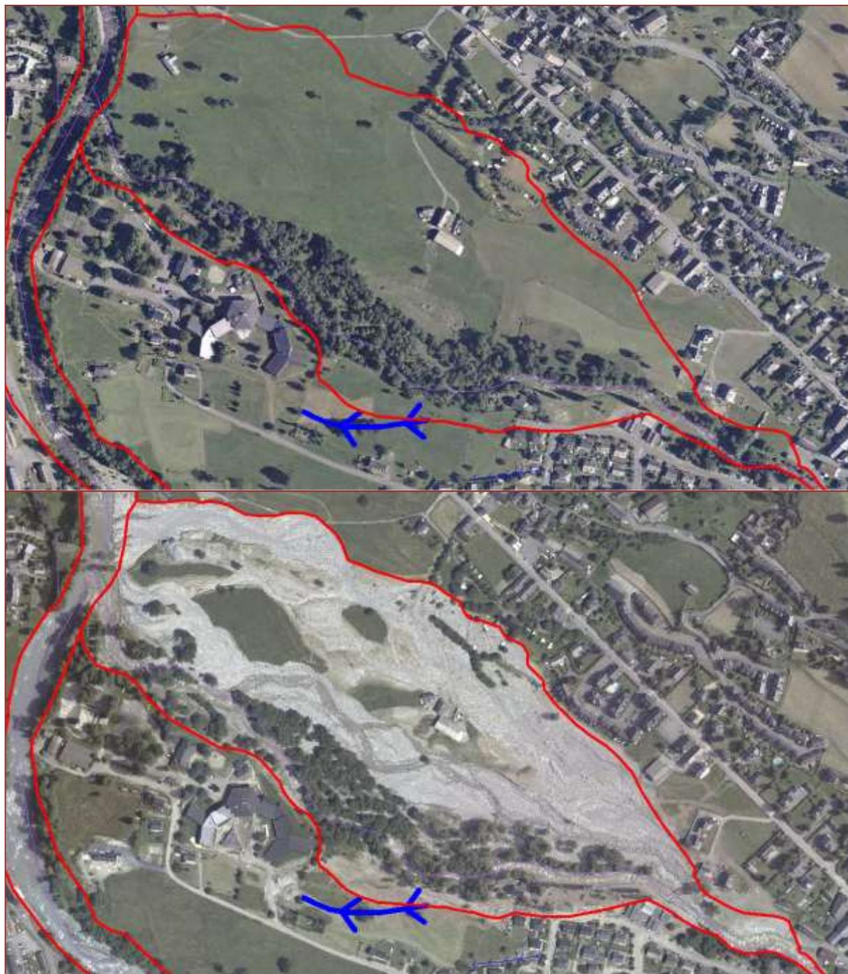
Mieux protégées (digue, enrochement), les zones bâties situées en bordure de la bande active ont également subi des dégâts, principalement du fait de l'activité de chenaux de crue, à l'origine d'inondation et d'apport de matériaux.
