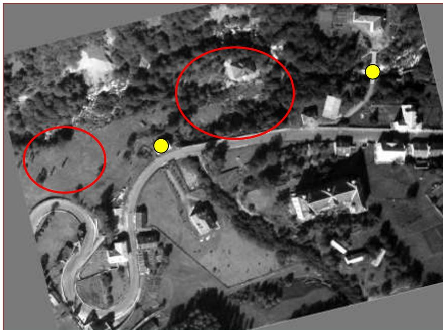
Le Bastan à Barèges (65) – le torrent en crue a contourné le bâtiment saillant qui a joué un rôle de déflecteur (source DDT65) – voir photo ci-après
