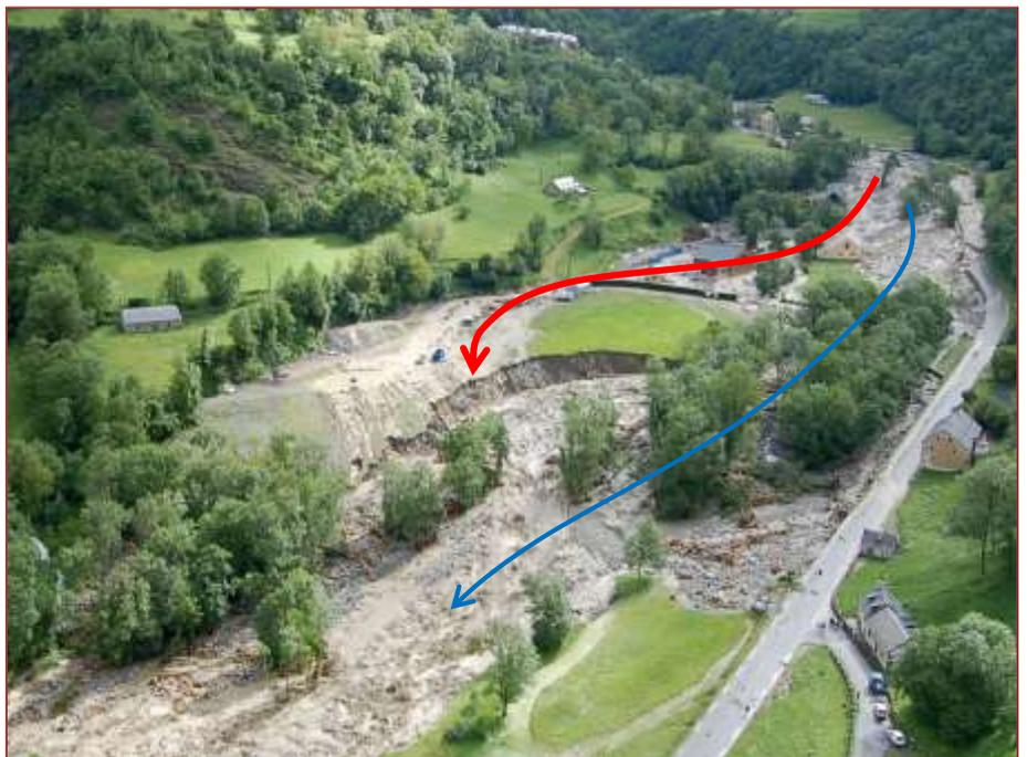
Le Bastan à Barèges (65) – le débordement dans le méandre amont a conduit à la submersion et à l'engravement des thermes de Barzun, malgré l'endiguement conçu pour les protéger (sources DDT65, en haut et CNRS-Géode, en bas)
