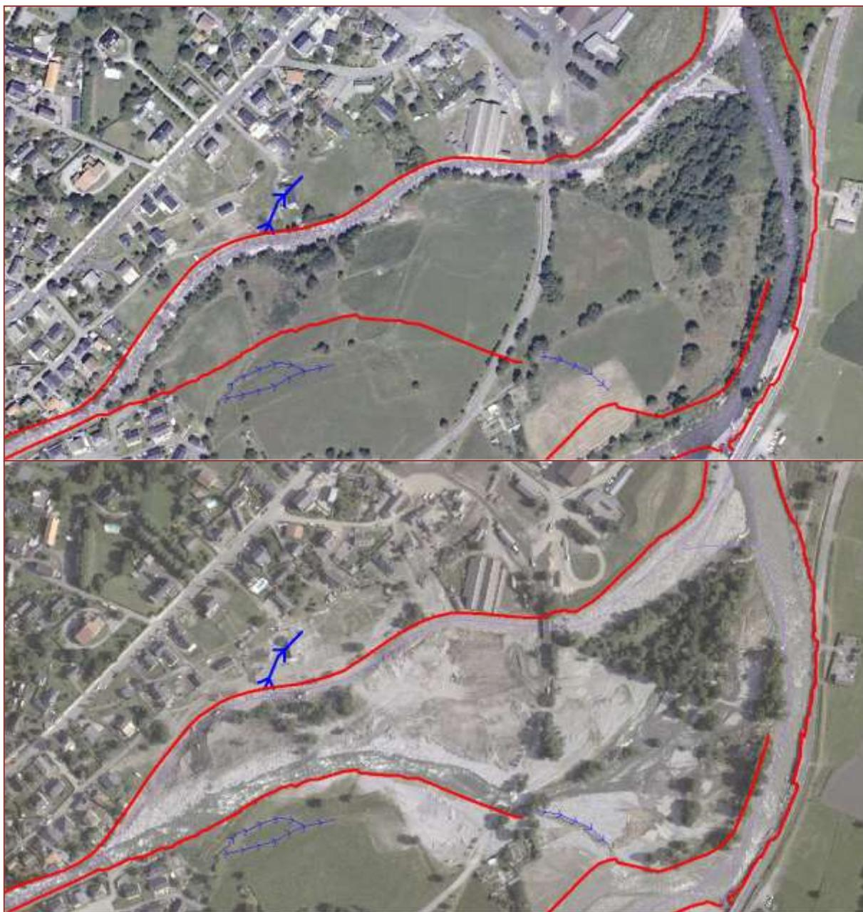
Mieux protégées (mur-digue, enrochement), les zones bâties et industrielles situées au Nord de la bande active ont également subi des dégâts, principalement du fait de surverses et de l'activité de chenaux de crue, à l'origine d'inondation et d'apport de matériaux.
