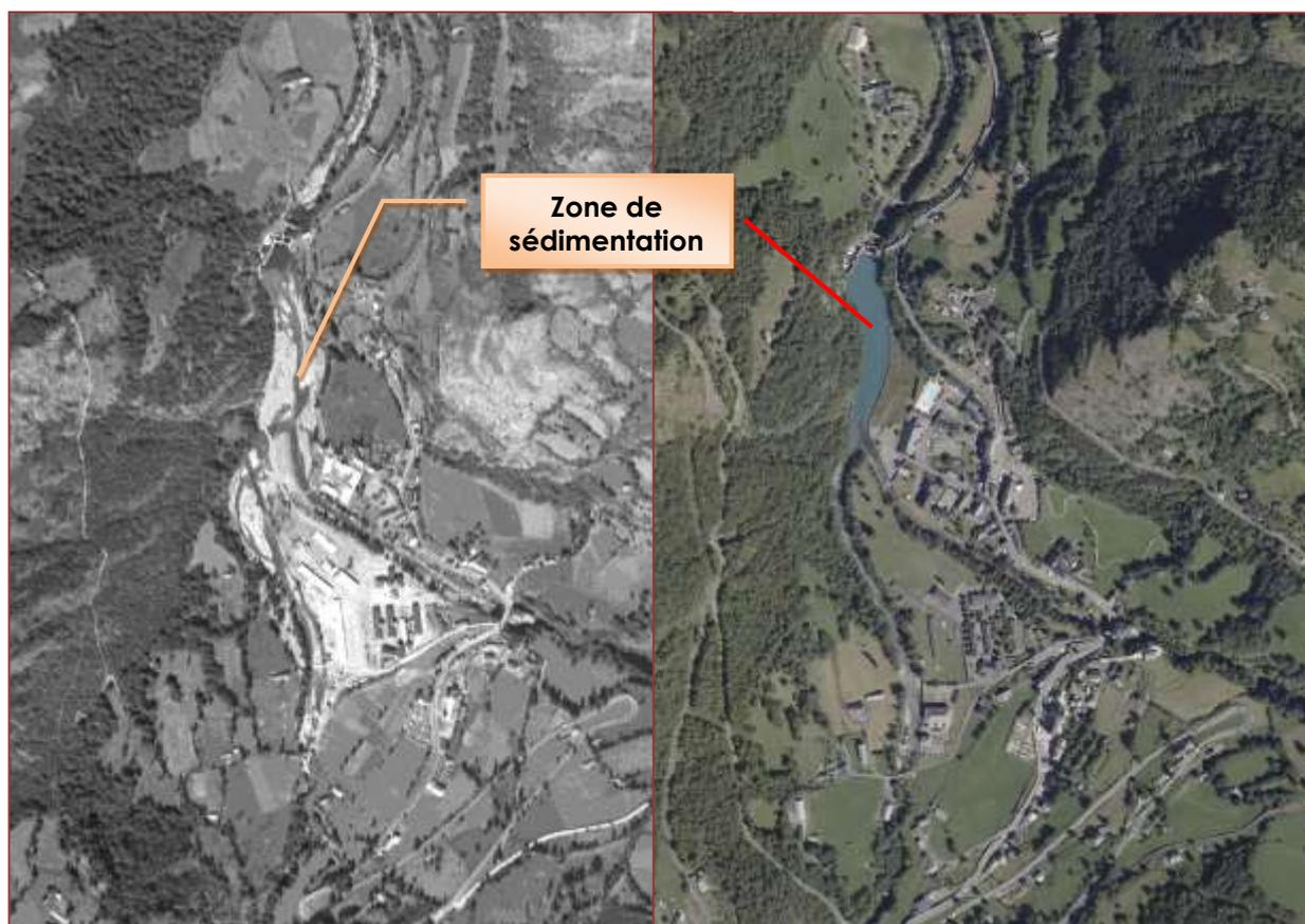
En général, les aménagements réalisés ayant conduit à accentuer la chenalisation du cours d'eau sur des linéaires significatifs, le processus de transit de la charge sédimentaire vers l'aval a été favorisé au détriment de la sédimentation sur place.
