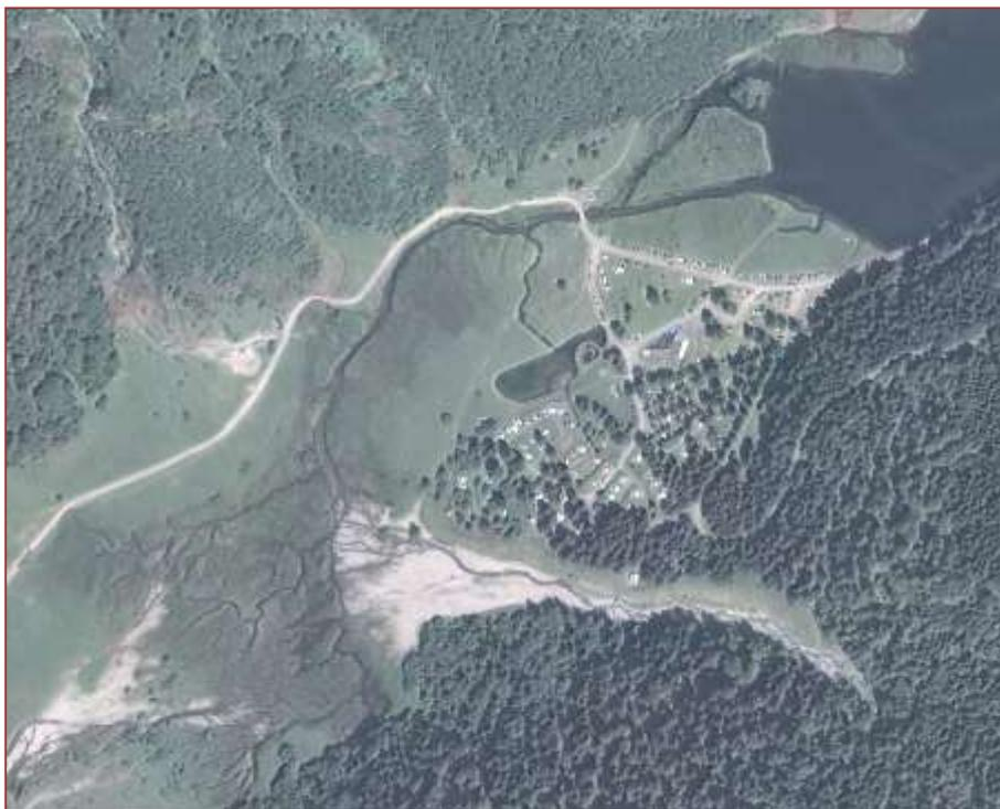
En aval du lac, le transport par charriage est actif et peu perturbé par les ouvrages ou aménagements existants (cartes S21 et S41). Il est à l'origine de la formation de bancs alluviaux, qui permettent l'implantation d'une végétation alluviale et la diversification des conditions d'écoulement et d'habitat aquatique.
