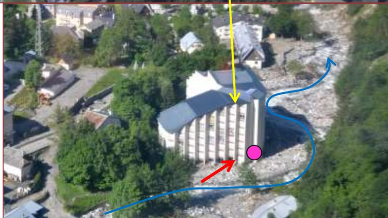
Le Bastan à Barèges (65) – le torrent en crue a contourné le bâtiment saillant, a détruit la protection de berge et érodé le versant en rive opposée
