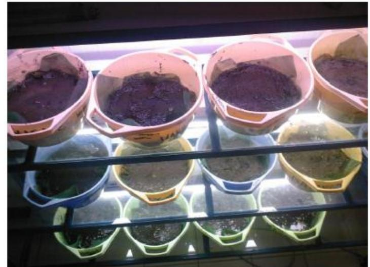
Figure 6 : Bassines contenant les sédiments mis en place dans la chambre chaude
