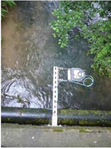
C'est à cet endroit qu'est installé un des limnimètres, en aval des carrières.
