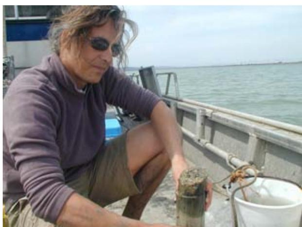
*Prélèvement de sédiment par carottage*
