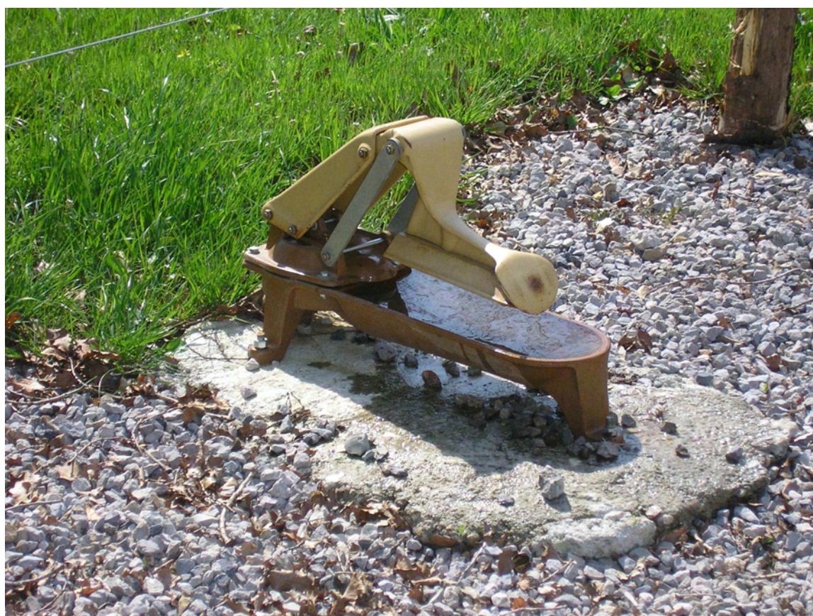
Photographie d'une pompe à museau Installée sur les marais du Cassan Prentegarde
