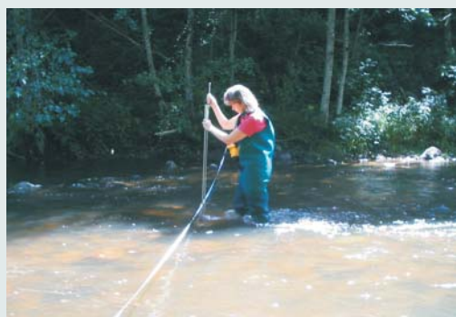
Mesure de débit sur la Dordogne le 11 août 2004 (station A du suivi qualité)
