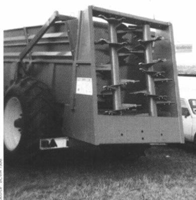
Les hérissons verticaux, au nombre de 2 ou 4, de grand diamètre, sont légèrement inclinés vers l'avant et tournent en sens inverse l'un de l'autre, de l'intérieur vers l'extérieur (le fumier passe entre les deux).
