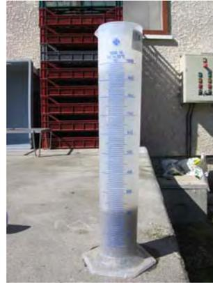
Système SBR enterré et réalisation du test à l'éprouvette
