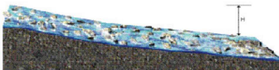
Figure 44- Schéma d'une rampe en enrochements
