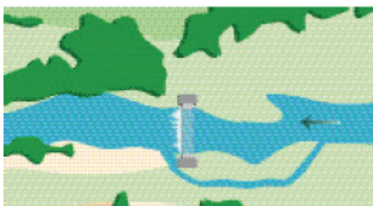
Figure 43- Schéma d'un canal de contournement
