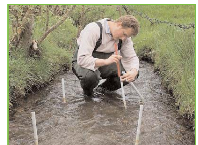
Mesure de l'oxygénation du fond du cours d'eau
