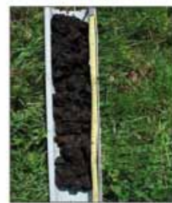
Une couche organique sombre : • Résultat de l'accumulation de matière organique non dégradée en absence d'aérogène • Sur une épaisseur d'au moins 30 cm • Engorgement permanent
