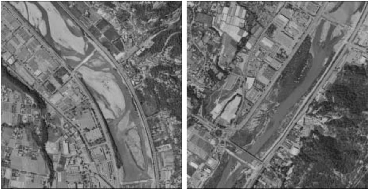
**Figure 26 – Observation des différents faciès morphologiques des écoulements du Var avec un lit en tresse (situation naturelle) et un lit vif chenalisé (influence des seuils)**
