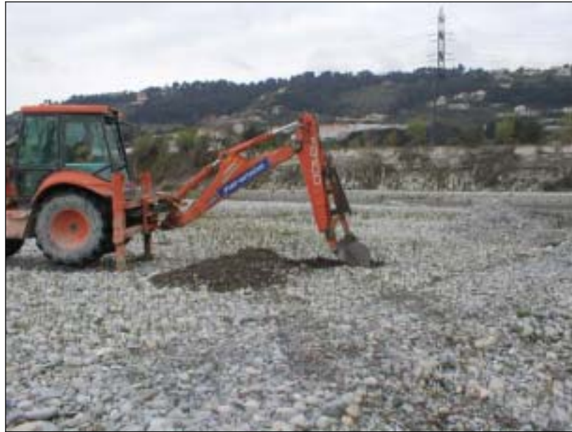
Prélèvements granulométriques dans la masse
