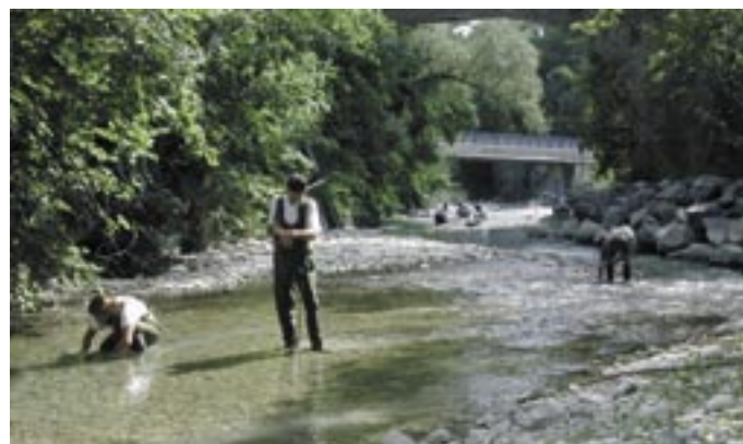
Prélèvements pour mesures IBGN
