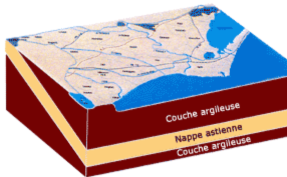
Figure 1 : vue schématique en trois dimensions de la nappe astienne
