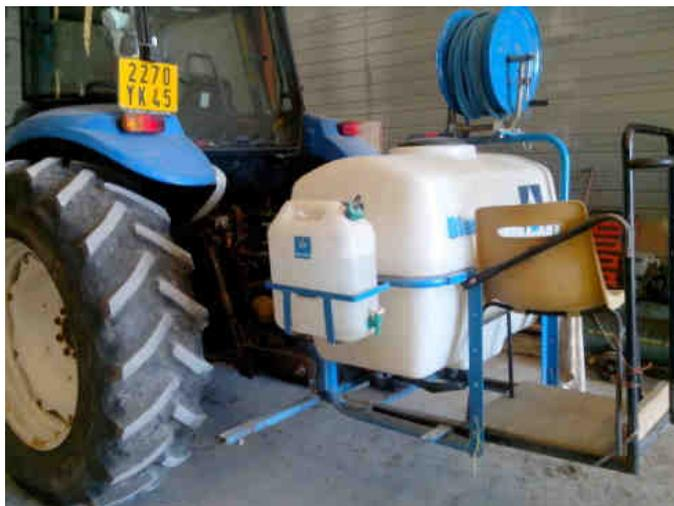
Figure 9 : Exemple de tonne tractée avec rampe sur le SAGE
