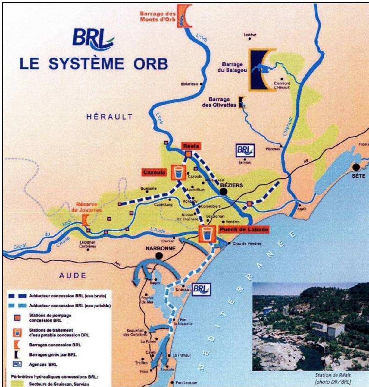
Outre la prise d'eau de Réals, BRL exploite 3 autres stations de pompage dans le fleuve, à Gaujac, Cessenon et Portiragnes, dont les prélèvements sont destinés principalement à l'irrigation agricole.
