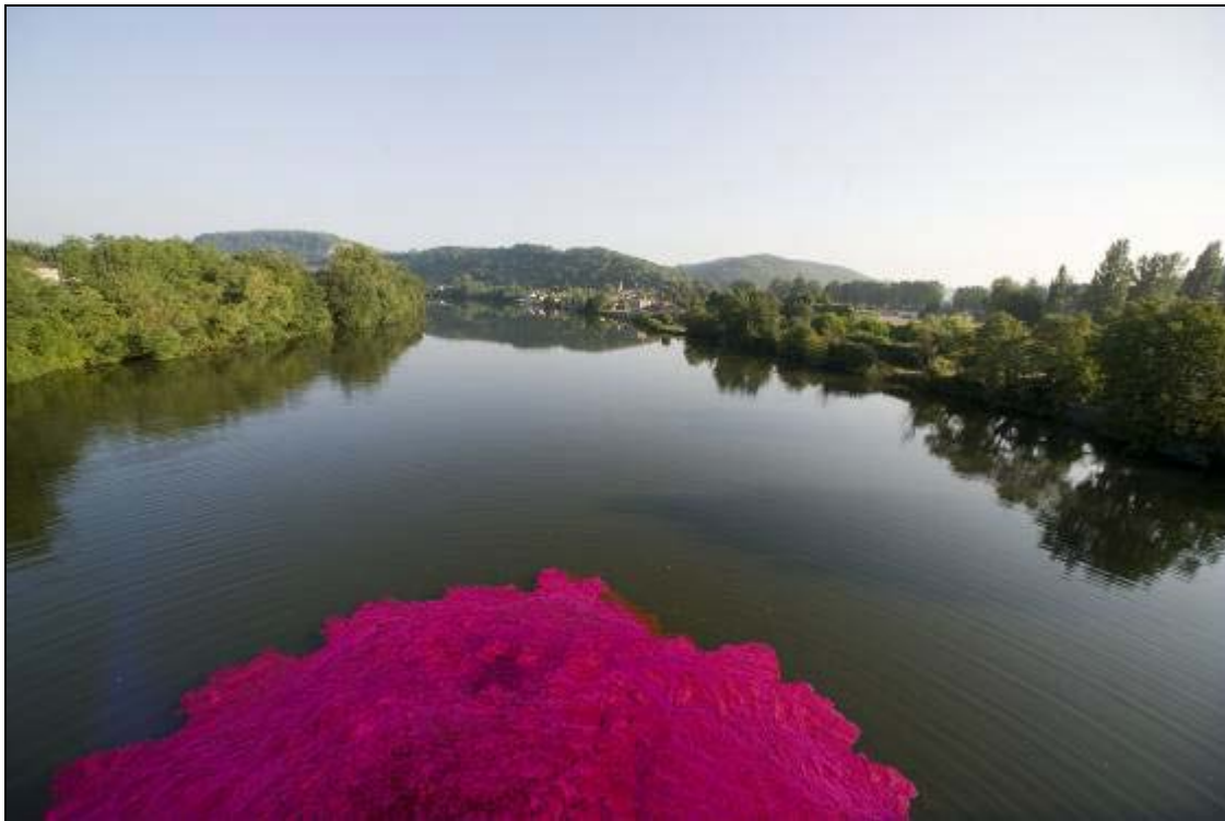
Traçage des eaux de Garonne pour simuler l'écoulement d'une nappe de pollution (@D. Taillefer – SMEAG)
