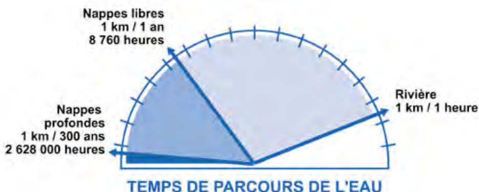
Illustration 5 : le compteur de vitesse de l'eau dans le milieu naturel (Hydro M)
