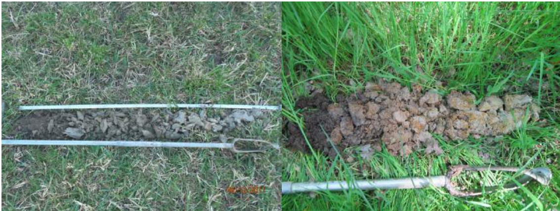
Photo 1 : Sondages à la tarière
