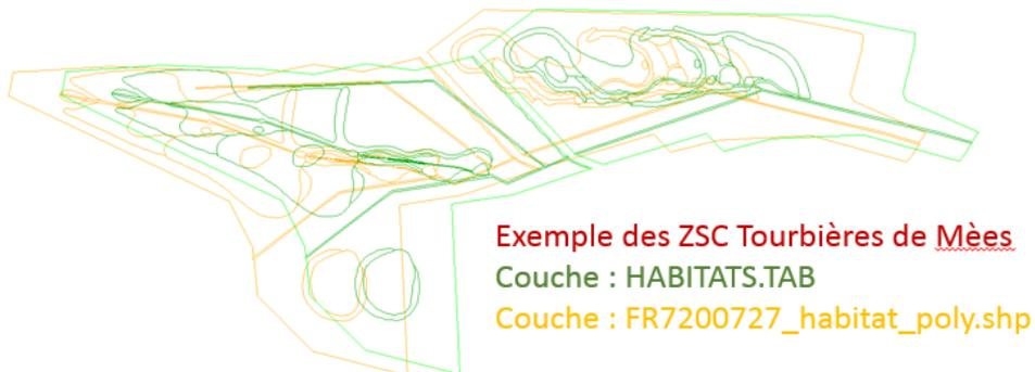
**Ici la projection est la même (L93) mais le passage d'un logiciel à un autre ou une mauvaise définition des paramètres a engendré ce décalage qui n'est peut-être pas homogène selon les cas.**
