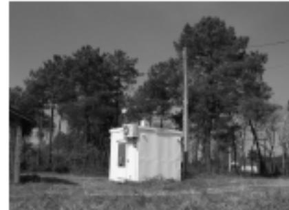
Cette station permet de suivre les teneurs en ozone (O<sub>3</sub>) et en oxydes d'azote (NO<sub>x</sub>).
