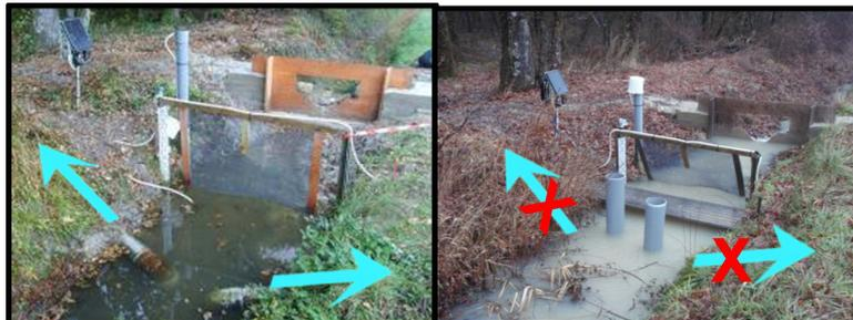
Figure 36 : Prises d'eau rustiques connectées à la ZTHA (site expérimental de Bray, Indre et Loire)
