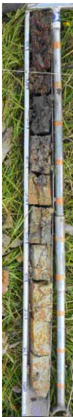
Photographies représentant des solshydromorphes : histosol avec à 70cm présence de roche mère (à gauche), réductisol oxydé (à droite), Source : FMA, 2014
