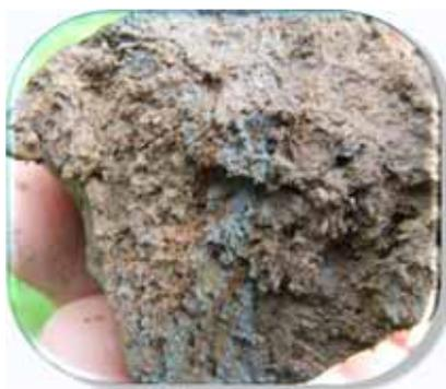
Les prélèvements à la **tarière** permettent de trouver des traces d'**oxydation** (rouille) ou de **réduction** (gris-bleu) de fer
