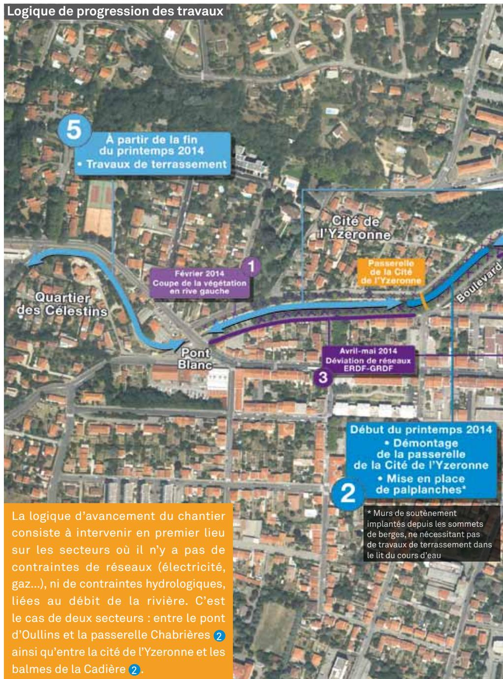
La logique d'avancement du chantier consiste à intervenir en premier lieu sur les secteurs où il n'y a pas de contraintes de réseaux (électricité, gaz...), ni de contraintes hydrologiques, liées au débit de la rivière. C'est le cas de deux secteurs : entre le pont d'Oullins et la passerelle Chabrières ② ainsi qu'entre la cité de l'Yzeronne et les balmes de la Cadière ②.
