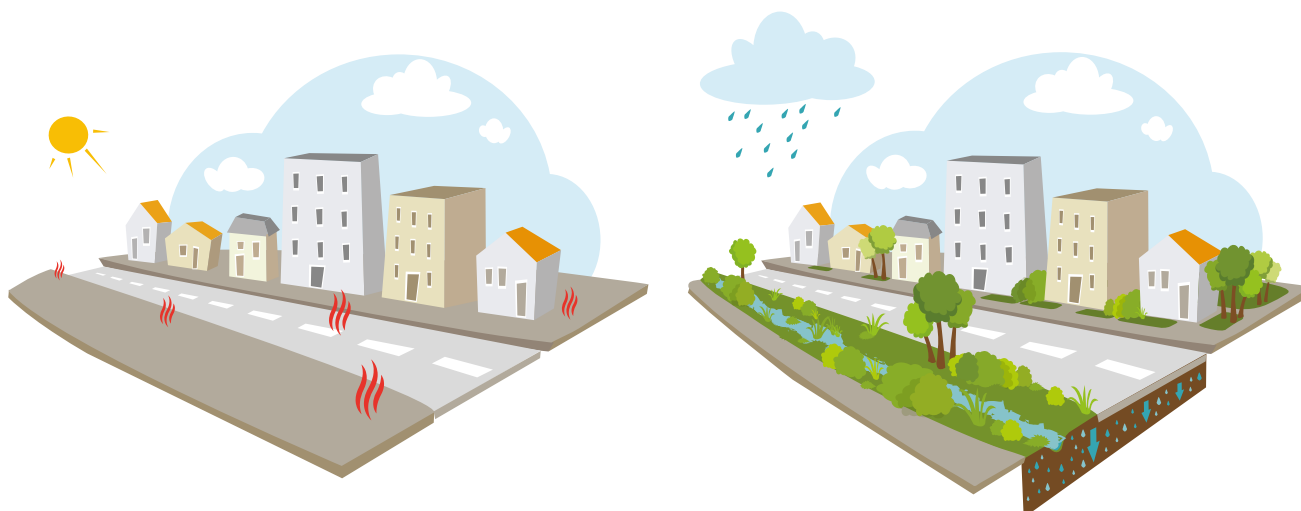
Les systèmes d'infiltration des eaux pluviales urbaines permettent de ramener de la nature en ville et de créer des îlots de fraîcheur.
