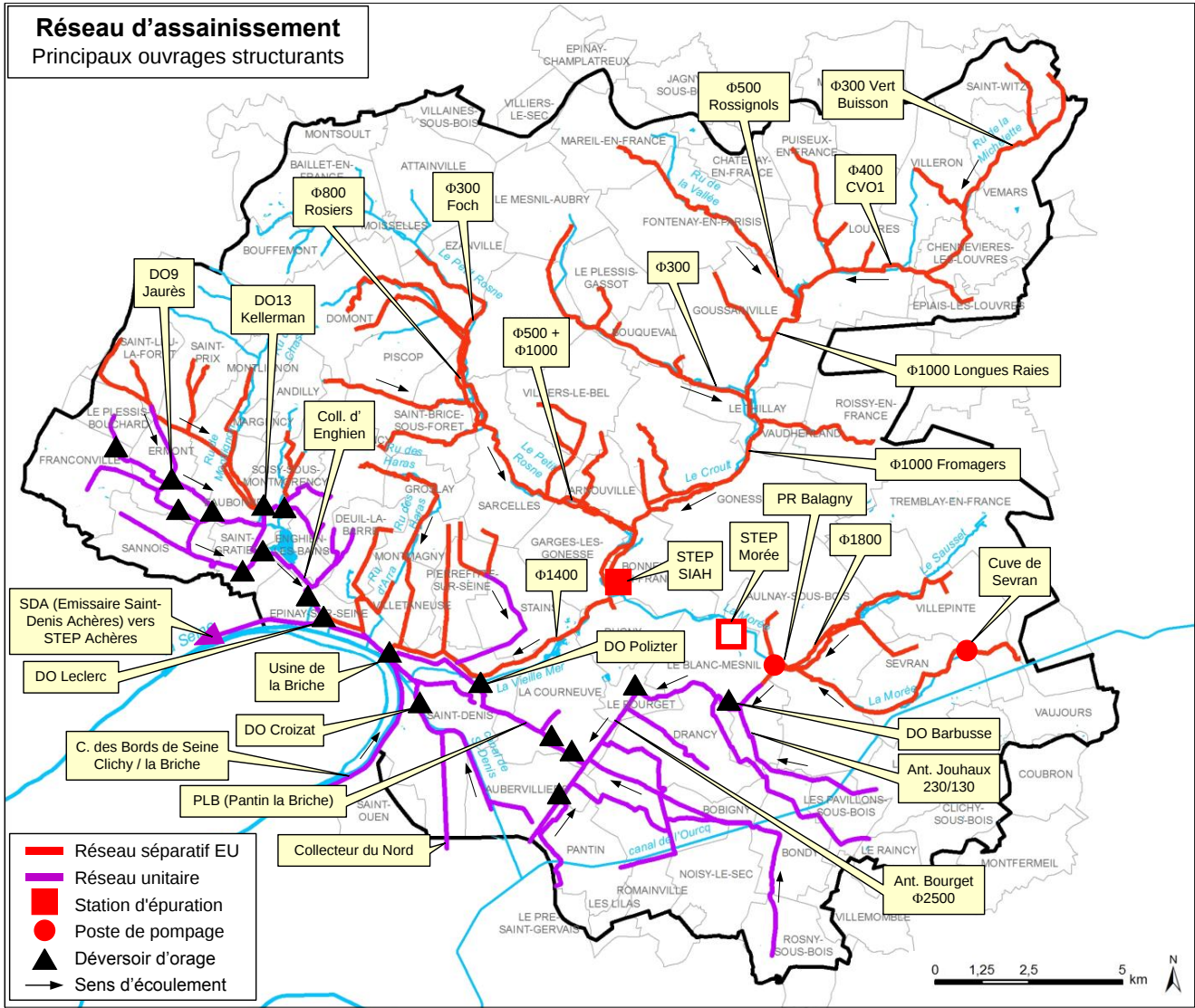
Figure 28 : Principaux ouvrages d'assainissement du territoire du SAGE
