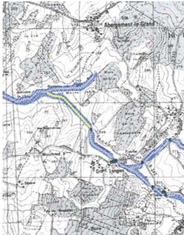
Figure 40 : Préconisation IPSEAU de projet de reméandrage sur la Grozonne
