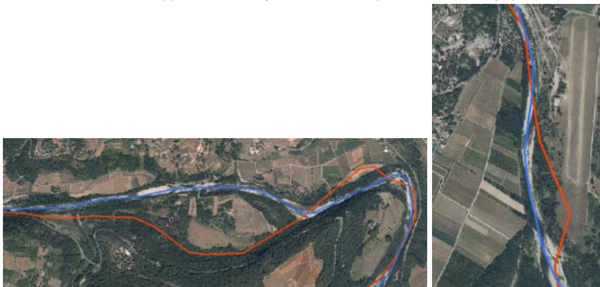
Représentation des tracés du cours d'eau en 1844 (carte d'Etat Major, en orange) et du tracé actuel (en bleu) : secteur de Vernon à gauche, de la confluence avec l'Ardèche à droite
