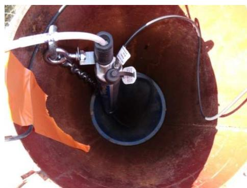
Figure 26 : Dispositif de suivi des niveaux d'eau sur un piézomètre de référence
