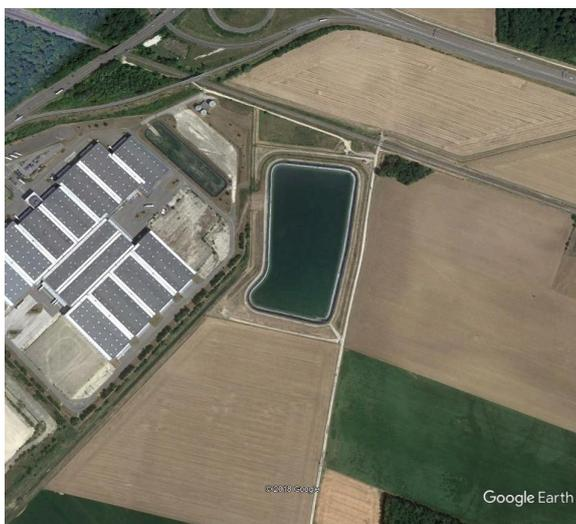
Dans ce domaine, l'irrigation agricole dispose déjà d'équipements (bassin de la Boulouze à Fauverney – 220 000 m<sup>3</sup> dont 140 000 m<sup>3</sup> réservés à l'irrigation) et envisage d'en développer d'autres. Le frein est avant tout financier, mais l'objectif de développement du maraîchage de proximité devra obligatoirement tenir compte de la disponibilité de la ressource et fort probablement du stockage en période pluvieuse.
