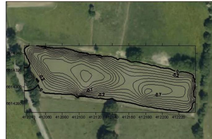
Figure 5 - 1ère bathymétrie obtenue sur le plan d'eau 369 - La Chaise Boire via Surfer
