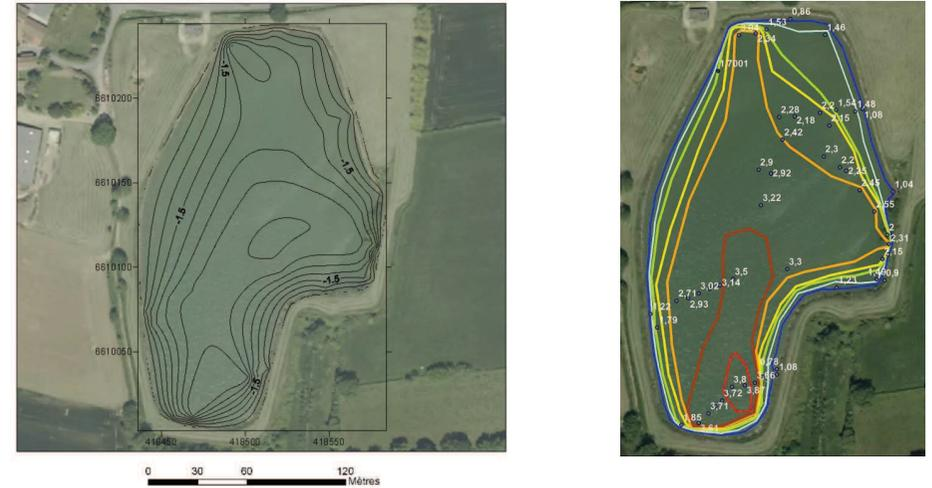
Figure 8 - 1ère bathymétrie obtenue sur le plan d'eau 1155 - La Lanfrère via Surfer (gauche) et à la main (droite)
