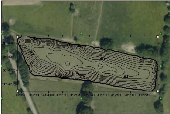
Figure 7 - Seconde bathymétrie obtenue sur le plan d'eau 369 - La Chaise Boire via Surfer
