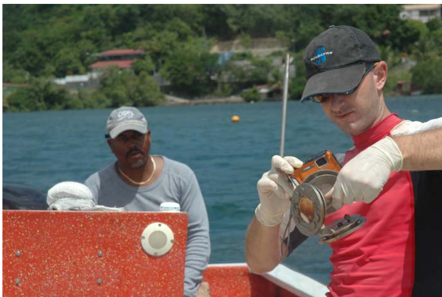
Photo : examen macroscopique d'une station POCIS(échantillonnage passif) en mai 2012
