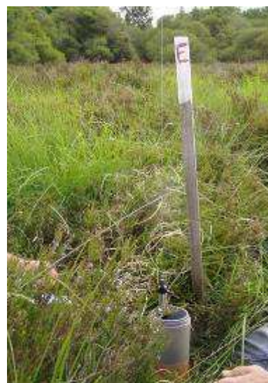
Installation de piézomètres dans le Tarn
