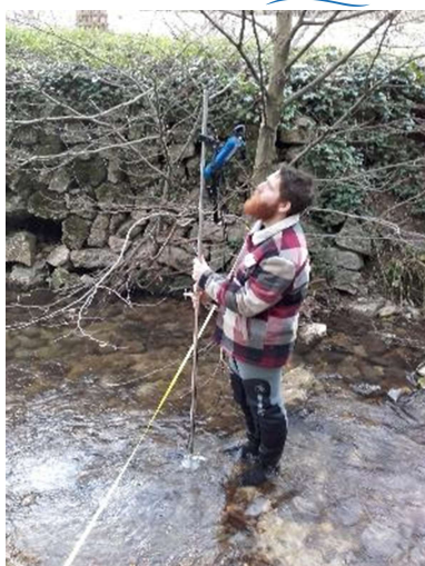
Figure 1: Réalisation d'une mesure de débit au courantomètre (à gauche) - Sonde du courantomètre (à droite)
