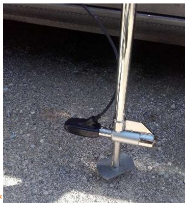
Figure 1: Réalisation d'une mesure de débit au courantomètre (à gauche) - Sonde du courantomètre (à droite)
