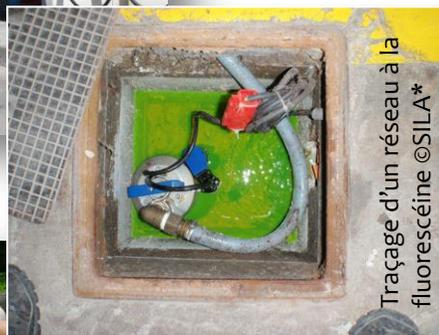
Traçage d'un réseau à la fluorescéine ©SILA\*
