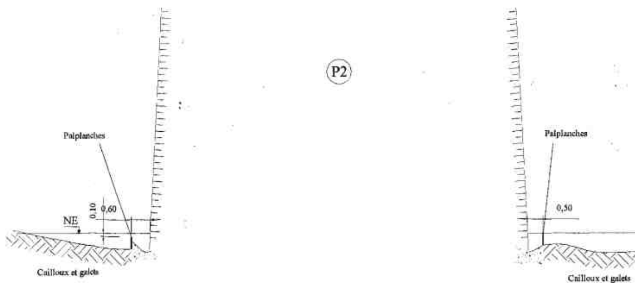
Figure 47 : Coupe BB de la pile n°2 (CG, 2008)
