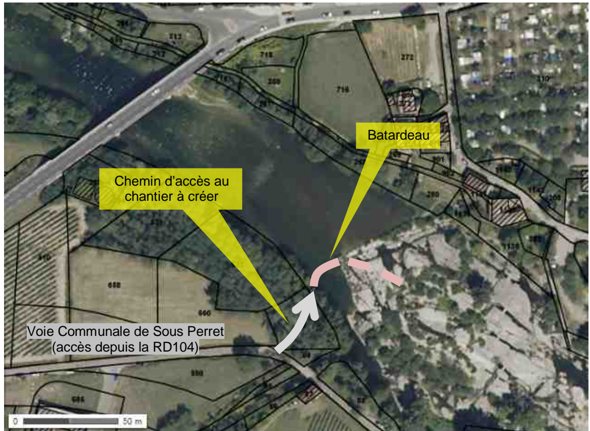
Figure 13 : Plan de principe des installations de chantier
