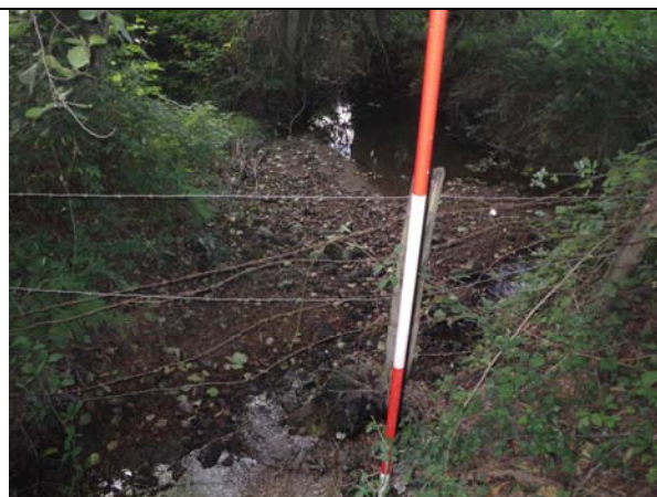
Photo 30 : Bancs de dépôts permettant de visualiser la nature du transport solide des affluents de tête de bassin (sable et graviers en majorité sur le tronçon APG3)
